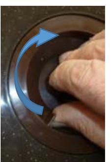
10. ホースガイドを外し、プラグ盤にホースを爪の根元まで差し込みキャップでしっかり締め付けます。プラグ盤の①をドラムの②に合わせ、ホースを引きながら位置を合わせ、締付穴にビスを入れてドライバーでビス固定します。
